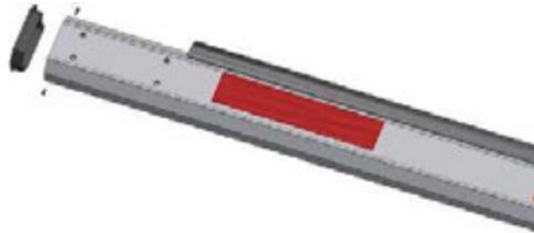
Fig. 36 : Retirer l'embout
